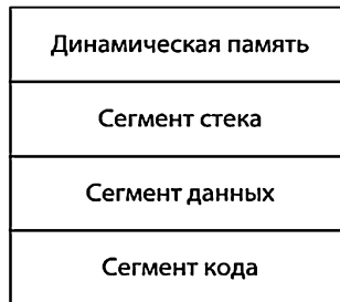
Рис. 4.6. Структура исполняемой программы в оперативной памяти
